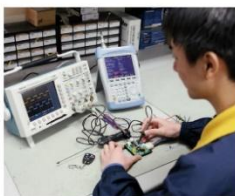
スペクトラムアナライザーによる電波波形検査
