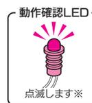
※何らかのセンサーが反応し、警報が鳴り始めると、動作確認 LED は反応したゾーンを示し始めます (P.18) が、ハイセキュリティ解除を行うとメモリはリセットされ、通常の点滅に戻ります。
