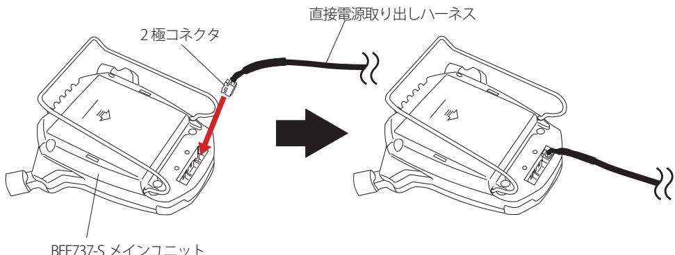
**2** 赤線を車両の(+)12VイグニッションON電源線に接続します。
